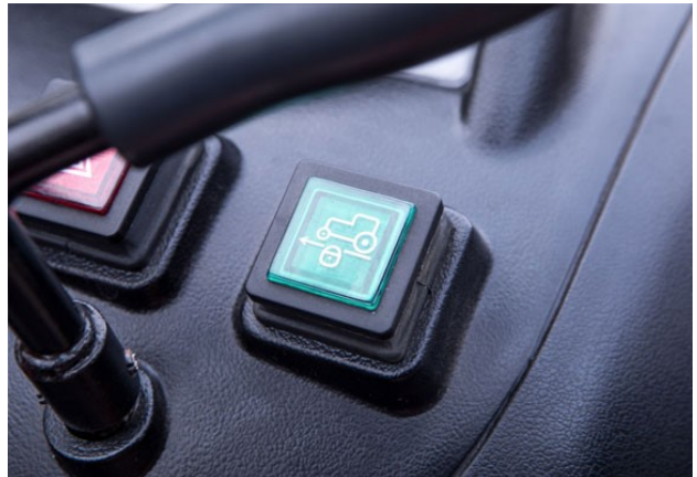
Handige bedieningsknop voor het inschakelen van de cruise-control.
