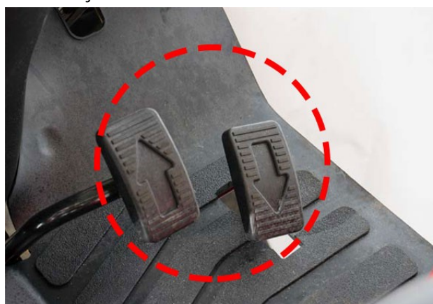
De Branson 00-serie hydrostaat wordt bestuurd door middel van twee voetpedalen. De 00-serie is ook verkrijgbaar met schakelbak.
