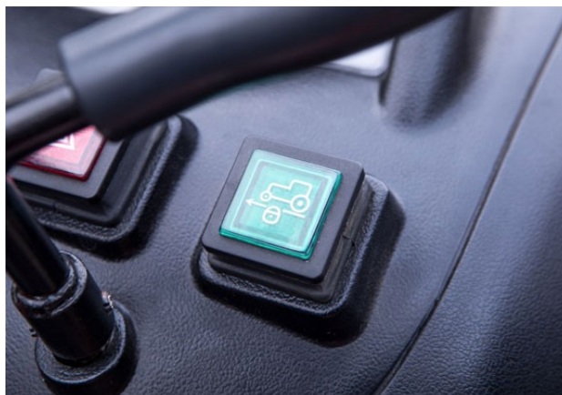
Handige bedieningsknop voor het inschakelen van de cruise-control.
